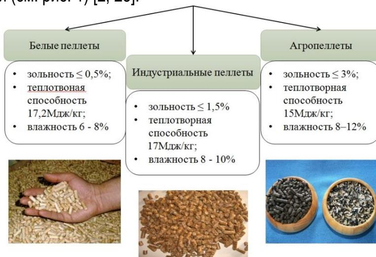
Рис. 1. Виды топливных гранул (пеллет)
